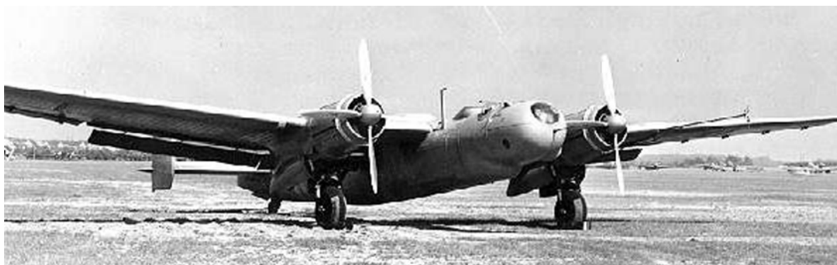
Junkers Ju 86, bombardier + reconnaissance - 2 moteurs de 600 CV chacun - Envergure : 22.5 m - Longueur : 17.87 m – Poids avec armement: 8 200 kg
